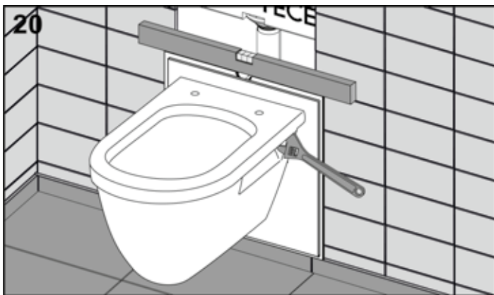
WC-Keramik montieren und ausrichten.
