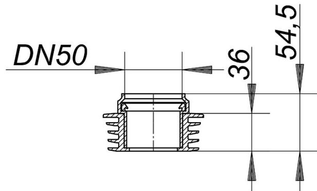
Anschlussstück mit Gummi-Muffendichtung und flexiblen Lippendichtungen aus TPE zum sicheren Anschluss von Badewannen an die Bodenabläufe CeraDrain Plan VC 12 und CeraDrain Plan K 12
