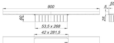
zum Einbau mit Ablaufgehäusen CeraFlex, CeraFlex Plan, CeraFlex senkrecht, DallFlex, DallFlex Plan, DallFlex senkrecht und Duschelementen DallFlex Wall, DallFlex Wall Plan.
