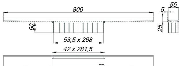
zum Einbau mit Ablaufgehäuse CeraWall, CeraWall Plan, DallFlex, DallFlex Plan, DallFlex senkrecht und Duschelement DallFlex Wall, DallFlex Wall Plan.
