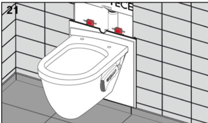
Überstehendes Material des Schallschutzsets abschneiden.
