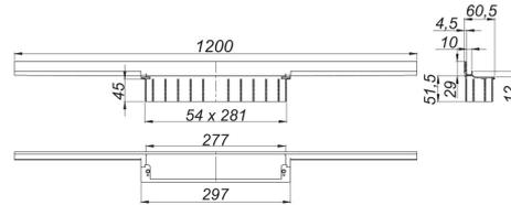
zum Einbau mit Ablaufgehäusen CeraFlex, CeraFlex Plan, CeraFlex senkrecht DallFlex, DallFlex Plan, DallFlex senkrecht und Duschelementen DallFlex Wall, DallFlex Wall Plan.
