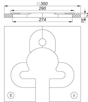
Zur einfachen und schnellen Einbau des Ablaufgehäuses DallDrain Plan in die Wärmedämmung.
