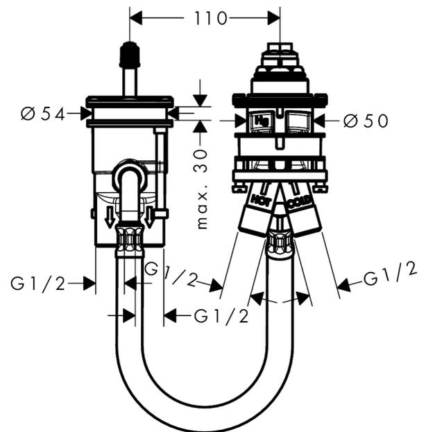
**Grundkörper für 2-Loch Wannенrandarmatur für Einhebelmischer**
