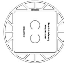
Aufsatz zum Befliesen mit individuellen Bodenbelägen, deren Schnittkanten poliert werden können, oder die durchgefärbt sind (z. B. Naturstein, Feinsteinzeug). Passend zu den Ablaufgehäusen und dem Aufstockelement DallDrain.
