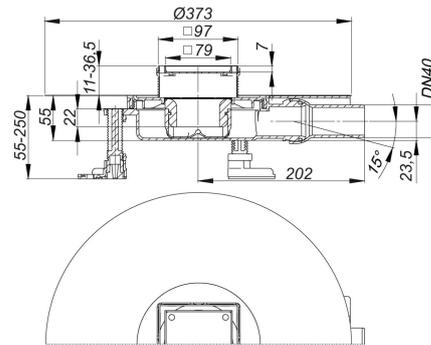
Bodenablauf inklusive Aufsatz Individual mit Edelstahlrahmen zum Befliesen mit individuellen Bodenbelägen. Ablaufstutzen DN 40 seitlich, mit Kugelgelenk, verstellbar von 0 – 15 Grad.
