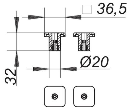
2 Justierschrauben lang, zur Montage/Höhenverstellung von CeraLine Abdeckungen in Bodenbelägen mit größerer Stärke, z. B. Naturstein
