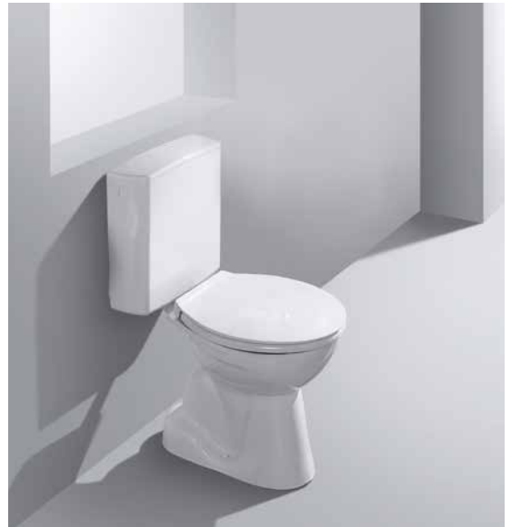
↑ Einbau tiefhängend, z. B. unterm Fenster. Minimale Einbauhöhe 800 mm.
