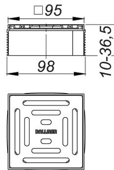
Aufsatz mit Edelstahlrost im Kunststoffrahmen, passend zu Ablaufgehäusen DallDrain, Aufstockelement DallDrain.
