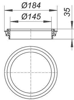
Ersatzteil zu Aufstockelementen CeraDrain und TistoDrain S 15.
