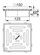
Aufsatz mit massivem Edelstahlrost im Edelstahlrahmen, passend zu den Ablaufgehäusen und dem Aufstockelement DallDrain.
