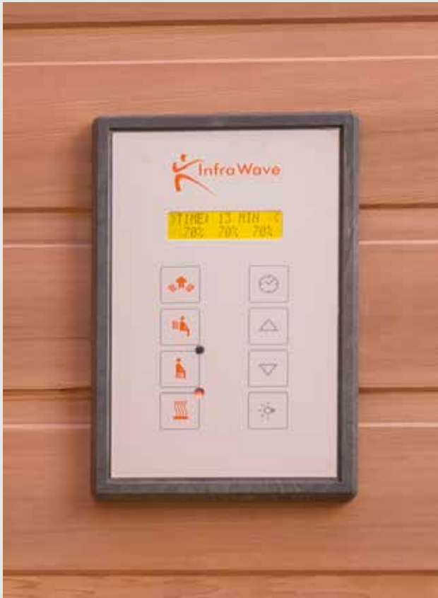
Advanced electronic control now also for leg heater and floor heating. Die Steuerung wurde weiterentwickelt und regelt auch Bodenheizung und Beinstrahler.
