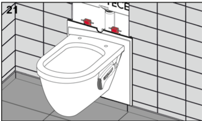
Überstehendes Material des Schallschutzsets abschneiden.
