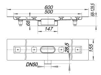
für die Montage in der Fläche mit einem Ablaufgehäuse, Ablaufstutzen DN 50 seitlich
