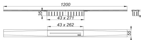
zum Einbau mit Ablaufgehäusen CeraFlex, CeraFlex Plan, CeraFlex senkrecht, DallFlex, DallFlex Plan, DallFlex senkrecht und Duschelementen DallFlex Floor, DallFlex Floor Plan, DallFlex Wall, DallFlex Wall Plan.
