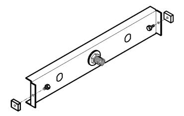
4.2 Gewindeplatten mit Sechskantschrauben SW 8 an der Befestigungstraverse montieren Sechskantschrauben nicht festziehen.
