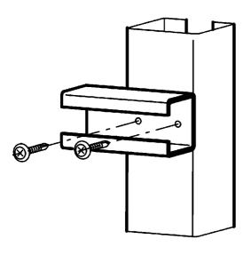
**4.1** C -Profile mit Bohrschrauben an den Profilen der Ständerwand befestigen.
