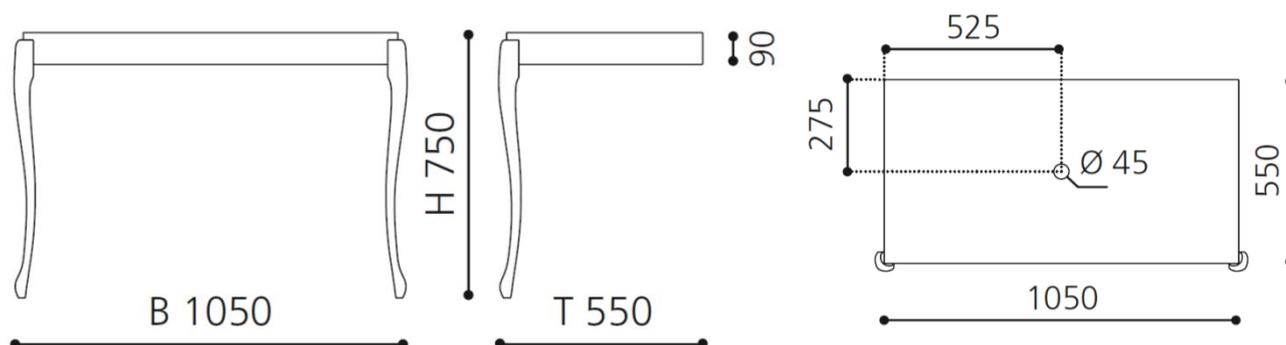
Die Maßtoleranzen (+/-3 mm) und Ebenheitstoleranzen (DIN 18202) unterliegen den üblichen materialspezifischen Toleranzen von Bau- und Werkstoffen, anlehnend an die DIN 18202. Lochbohrungen müssen nach Auflegen des Waschtisches auf die Trägerplatte angezeichnet werden.
