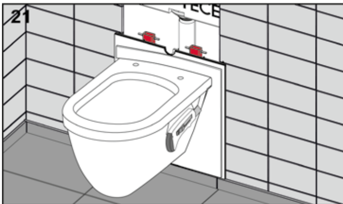
Überstehendes Material des Schallschutzsets abschneiden.
