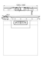
mit wandseitiger Ablaufstelle zum Einbau mit Duschrinnen CeraWall und CeraFloor. Ablaufstutzen DN 50 seitlich, werkzeuglos an drei Seiten variabel montierbar, mit Kugelgelenk verstellbar von 0 – 15 Grad
