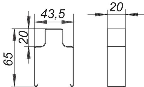
zur einfachen Entnahme aller Abdeckungen CeraLine sowie zum Sperren und Entsperren der verriegelbaren Ausführungen.
