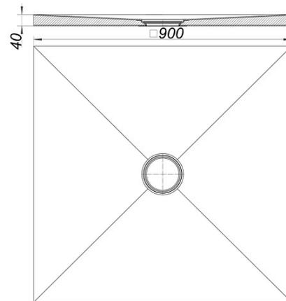
wasserdichte Duschelemente zur direkten bodengleichen Verfließung, mit zentraler Ablaufstelle
