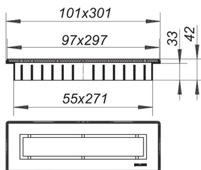
zum Einbau mit Ablaufgehäusen CeraFlex, CeraFlex Plan, CeraFlex senkrecht, DallFlex, DallFlex Plan, DallFlex senkrecht und Duschelementen DallFlex Compact, DallFlex Compact Plan.
