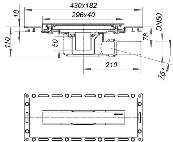
Ablaufstutzen DN 50 seitlich, mit Kugelgelenk, verstellbar von 0 – 15 Grad
