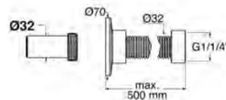
RACCORDO Joint flexible Ablaufverbindung für wandgebundene Standwaschtische, Verbindung vom Ablaufventil zum UP-Siphon
