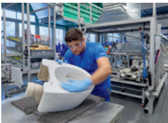
Montage von Dusch-WCs...
