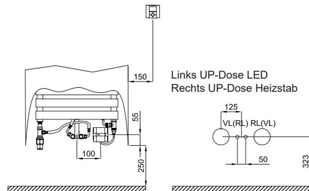
Für eine barrierefreie Installation empfiehlt es sich, den UP-Anschluss für die LED-Hinterleuchtung extern über einen Schalter (beispielsweise aus dem Schalterprogramm der Hauselektrik) ein- und auszuschalten, da der serienmäßig mitgelieferte Schalter unten hinter der Front platziert ist.
