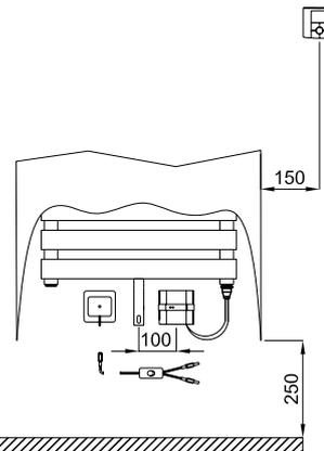
Gezeichnetes Beispiel zeigt Elektroheizstab Serie P mit Funk Raumregelung Komfort sowie zus. Anschluss für LED-Hinterleuchtung.
