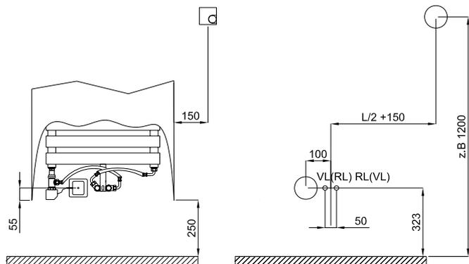
Unterputzinstallation für Elektroanschlüsse für Heizstab und LED-Hinterleuchtung
