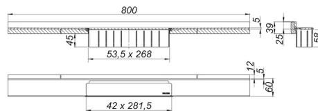
zum Einbau mit Ablaufgehäusen CeraFlex, CeraFlex Plan, CeraFlex senkrecht, DallFlex, DallFlex Plan, DallFlex senkrecht und Duschelementen DallFlex Wall, DallFlex Wall Plan.
