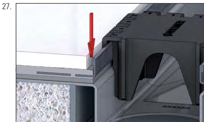
DE Fuge mit zementärem oder elastischem Fugenfüller schließen
