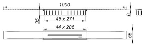
zum Einbau mit Ablaufgehäusen CeraFlex, CeraFlex Plan, CeraFlex senkrecht, DallFlex, DallFlex Plan, DallFlex senkrecht und Duschelementen DallFlex Floor, DallFlex Floor Plan, DallFlex Wall, DallFlex Wall Plan.
