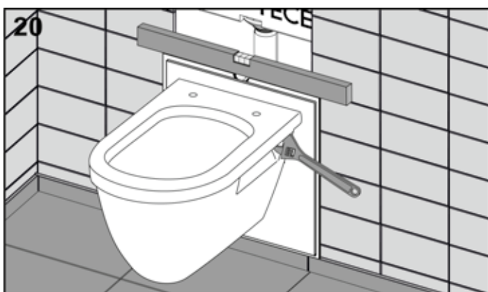
WC-Keramik montieren und ausrichten.
