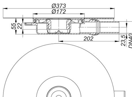
Zum Einbau mit Aufsätzen DallDrain, Aufstockelement DallDrain. Ablaufstutzen DN 40 seitlich, mit Kugelgelenk, verstellbar von 0 – 15 Grad.
