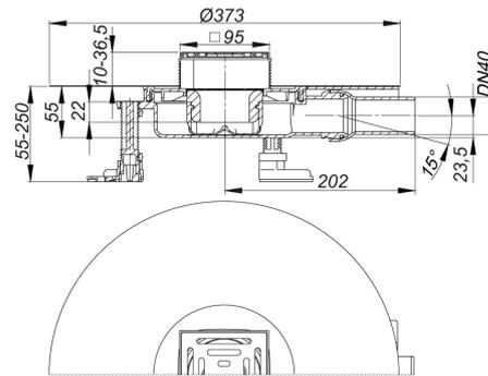
Bodenablauf inklusive Aufsatz mit Edelstahlrost im Kunststoffrahmen. Ablaufstutzen DN 40 seitlich, mit Kugelgelenk, verstellbar von 0 – 15 Grad.
